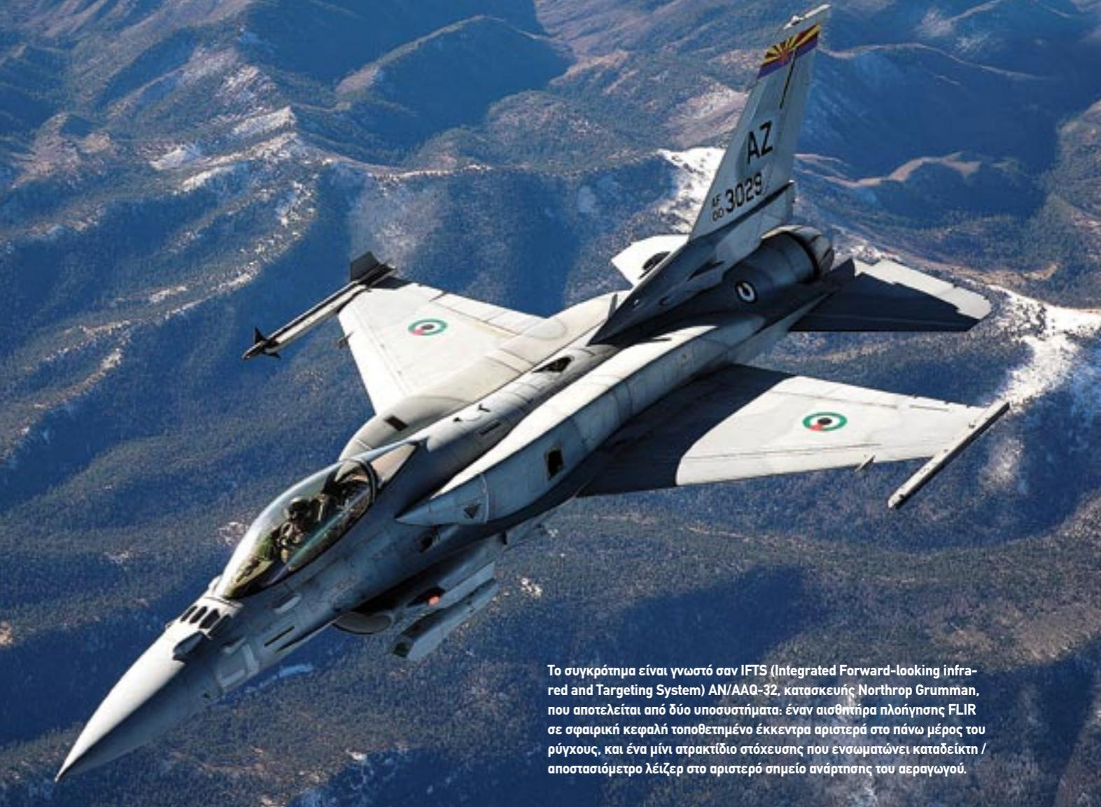
Το συγκρότημα είναι γνωστό σαν IFTS (Integrated Forward-looking infra-red and Targeting System) AN/AQ-32, κατασκευής Northrop Grumman, που αποτελείται από δύο υποσυστήματα: έναν αισθητήρα πλοήγησης FLIR σε σφαιρική κεφαλή τοποθετημένο έκκεντρα αριστερά στο πάνω μέρος του ρύγχους, και ένα μίνι ατρακτίδιο στόχευσης που ενσωματώνει καταδείκτη / αποστασιόμετρο λείζερ στο αριστερό σημείο ανάτησης του αεραγωγού.
