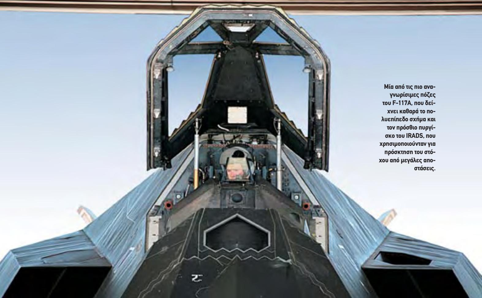
Mία από τις πιο αναγνωρίσιμες πόζες του F-117A, που δείχνει καθαρά το πολυεπίπεδο σχήμα και τον πρόσθιο πυργίσκο του IRADS, που χρησιμοποιούνταν για πρόσκτηση του στόχου από μεγάλες αποστάσεις.
